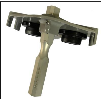
Abb. 2 Die Tragestange wird an einer Seite eingesteckt
