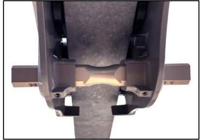
Fig 5. Vis de blocage bien vissées creux
