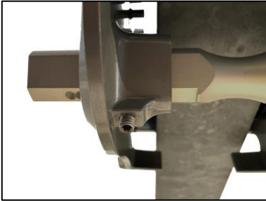
Fig 4 Stoppskruv och fördjupningar
