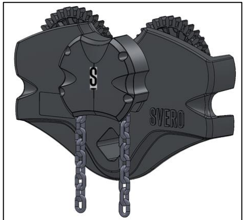
Kuva 6 Palkkivaunussa 23G on käsikettinkikäyttö
