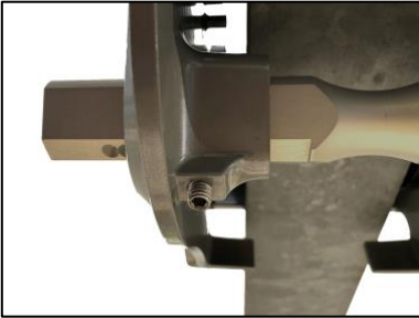
Kuva 4 Kiinnitysruuvi ja syvennykset
