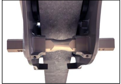
5 pav. Tvirtai priveržti stabdiklio varžtai
