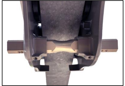
Kuva 5 Kiinnitysruuvit lujalle kiristettyinä
