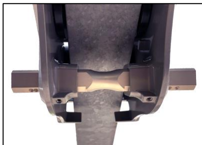
Fig. 5 Stopskruerne hårdt spændt
