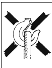
Fig 4 c Krokspärren blockerad!
