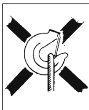
Fig 4 a Slinget belastar krokspetsen!
