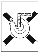
Fig 4 d Krokspetsen dessutom utsatt för böjpåkänning!
