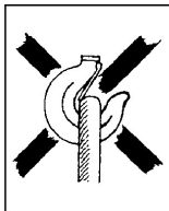
Fig 2 c Krokspärren blockerad!
