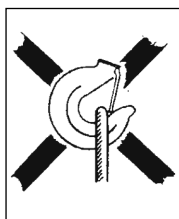
Fig 4 a Slinget belastar krokspetsen!
