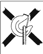
Fig. 4 a Slyngen belaster krokspissen!
