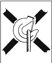
Kuva 4 a Silmukka kuormittaa koukun kärkeä!
