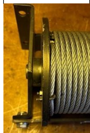
Abb. 3 Bügelsschraube sichert das Seil
