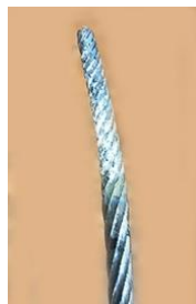
Kuva 1 Kiinnitetty vaijerin pää
