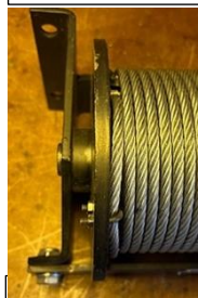
Illustrasjon 3 U-bolt sikrer tauet
