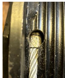
Fig. 2 Stålwires ende med monteret presselås
