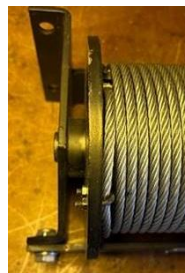
Fig 3 U-bolt fastgør wiren
