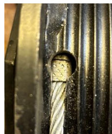
III. 2 Ståltau med påsatt trykklås
