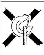
Fig. 2 a Slyngen belaster krokspissen!
