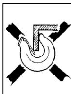
Fig 2 d Krokspetsen dessutom utsatt för böjpåkänning!
