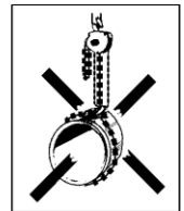
Fig. 2 e Lastekjettingen må ikke brukes som slynge!
