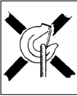
Kuva 2 a Silmukka kuormittaa koukun kärkeä!
