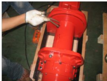
Fig. 10 Stålvaieren festes i vaiertrommelen.
