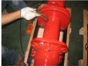
Kuva 10. Teräsvaijerin kiinnittäminen rummulle.
